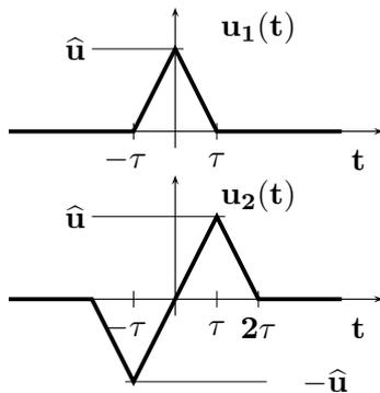
Entnehmen Sie für die weiteren Berechnungen die zu  $u_1(t)$  gehörige Spektraldichtefunktion  $\underline{U}_1(j\omega)$  dem Skriptum.
