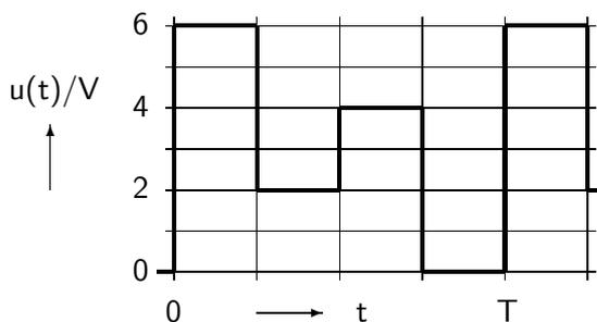
sind zu berechnen der Effektivwert  $U_{\text{eff}}$ , der Gleichspannungsmittelwert  $\bar{U}$ , der Formfaktor  $\delta$ , der Scheitelfaktor  $\sigma$  sowie die Wirkleistung  $P$ , die in einem  $50 \Omega$ - Widerstand umgesetzt wird, der an die Spannung  $u(t)$  angeschlossen ist.
