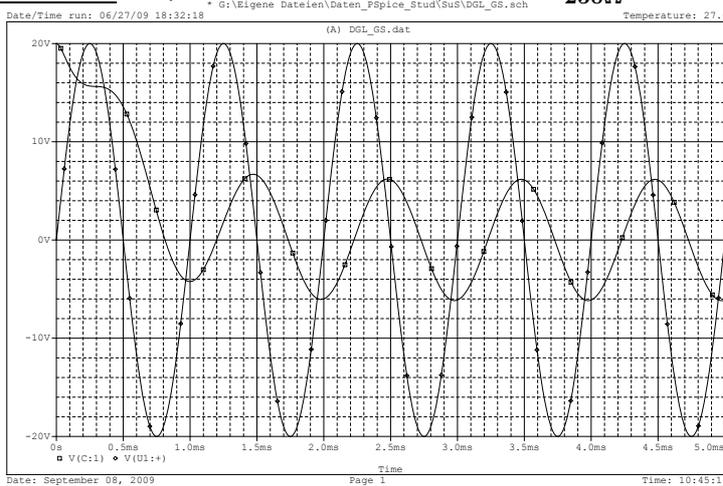
d.) Das Netzwerk ist nicht schwingungsfähig, da der Übergang vom Anfangswert der Spannung an C zu dem neuen eingeschwungenen Zustand (sinusförmiges Signal der Frequenz 1 kHz, Amplitude ca. 6.1 V, gegen die Eingangsspannung um ca. 80° nacheilend) nicht mit einer gedämpften Schwingung sondern exponentiell erfolgt.
