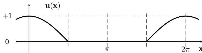
Berechnen Sie ausgehend von der Fourier-Reihe zu  $f_{12}(x)$  auf Seite 16 unter Berücksichtigung der 'Zeitverschiebung' die zur dargestellten Spannung  $u(x)$  gehörige reelle Fourier-Reihe.
