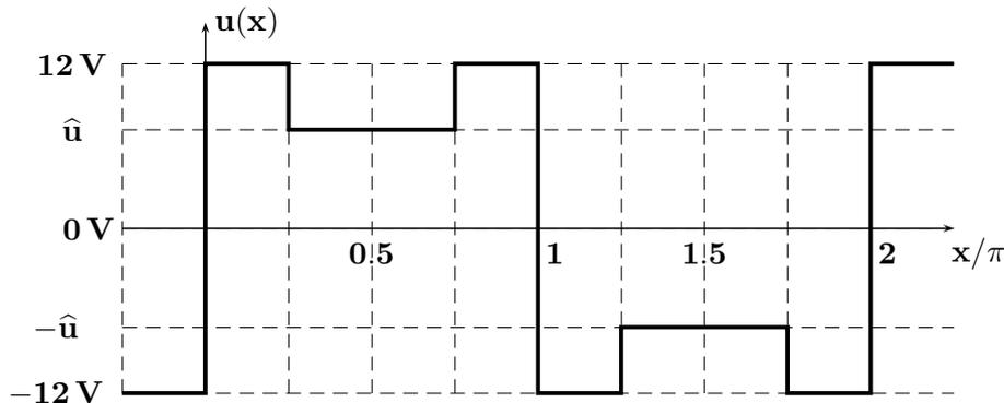
**Ü 10 ( III/30 min ):** Berechnen Sie die reellen Fourier-Koeffizienten  $a_0, a_n, b_n$  sowie  $A_n$  der  $2\pi$ -periodischen Spannungen. Die Größe  $e$  beschreibt die normierte 'Einschaltdauer'.
