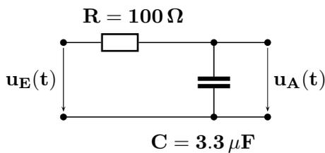
Gegeben ist die Eingangsspannung  $u_E(t)$  mit der Grundfrequenz  $f_1 = 500 \text{ Hz}$ .
