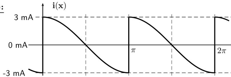
Ermitteln Sie ausgehend von im Skriptum enthaltenen Fourier-Reihen die reellen Fourier-Koeffizienten  $a_0$ ,  $a_1$ ,  $a_2$ ,  $b_1$  und  $b_2$  der im Bild dargestellten periodischen Stromfunktion.
