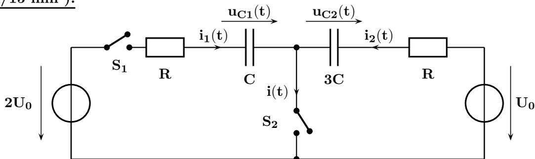
Zunächst sind die Schalter  $S_1, S_2$  geöffnet und beide Kondensatoren ungeladen.
