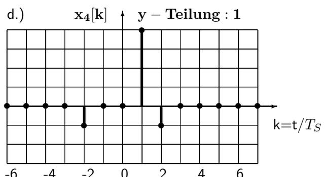
**Ü 61 ( III/15 min ) :** Berechnen Sie die Fourier-Transformierte  $\underline{U}(f)$  des zeitdiskreten Signals  $u[k]$ . Ermitteln Sie für  $T_S = \frac{1}{f_S} = 1 \mu\text{sec}$  die Beträge bei den Frequenzen  $f = 0 \text{ MHz} ; 0.5 \text{ MHz} ; 1 \text{ MHz}$  und skizzieren Sie den Betragsverlauf im Bereich  $-1 \text{ MHz} \leq f \leq 4 \text{ MHz}$ .
